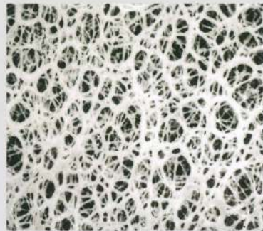
0.2μmアブソリュート メンブレン・フィルターの表面
